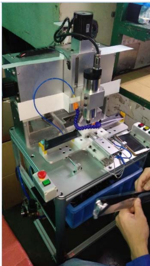
YJ17031模具自动切水口 治具照片
