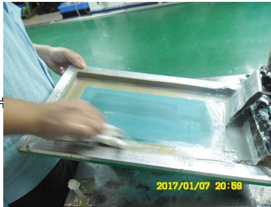
**实施内容：**第一款产品完成后，丝印工立即着手进行洗网收油动作，完成后快速进入下一款生产。
